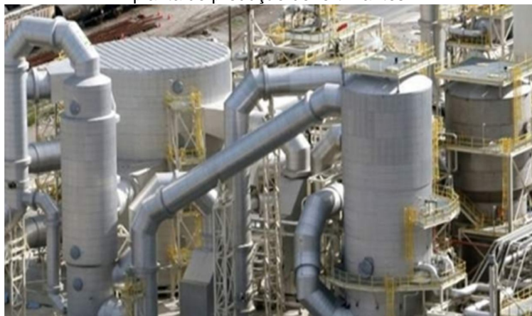
Figura 1 Visão geral de um sistema, em alumínio, para transporte e armazenamento de ácido nítrico, planta de produção de fertilizantes.
