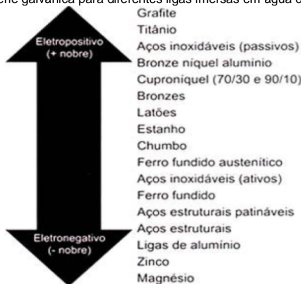
Figura 19 Série galvânica para diferentes ligas imersas em água do mar, a 25°C.
