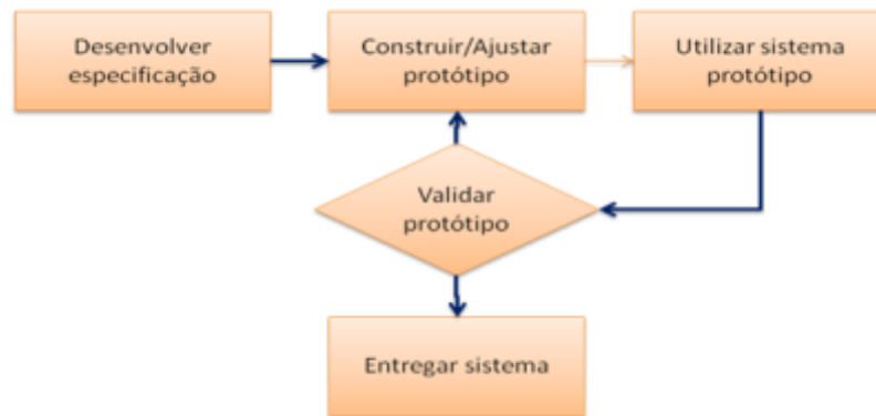
Figura 3.23: Fluxograma de prototipação evolucionária usado na construção do sistema.
