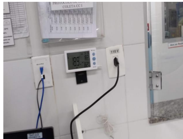
Figura 01: Medidor de temperatura e umidade - Sala de lavagem
