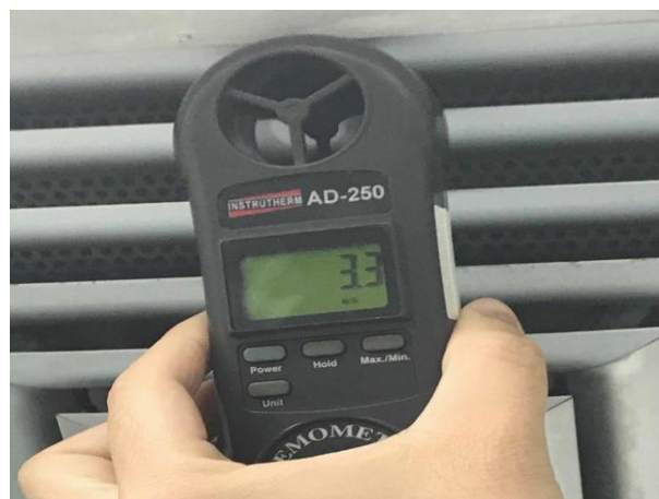
Figura 07: Anemômetro utilizado nas medições
