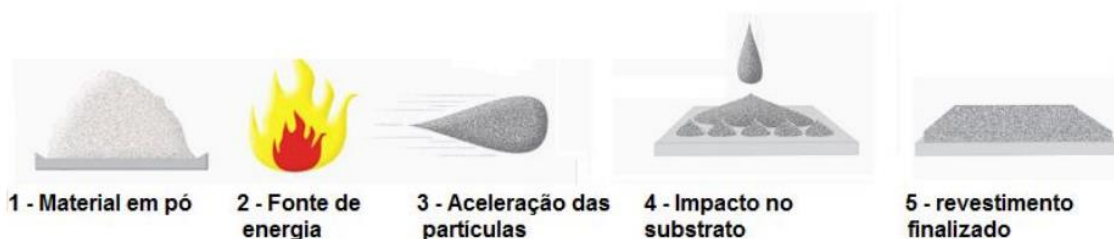
Figura 1 - Desenho esquemático de um processo de aspersão térmica
