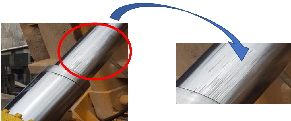
Figura 6 – Haste de Cilindro com desgaste aparente
